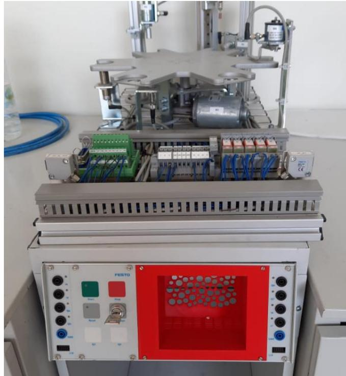
Ilustración 138. Celda de manufactura FESTO MPS.
